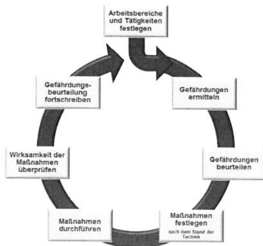
Abb.2: Einzelschritte und Gesamtprozess der Gefährdungsbeurteilung (Quelle: DGUV)
